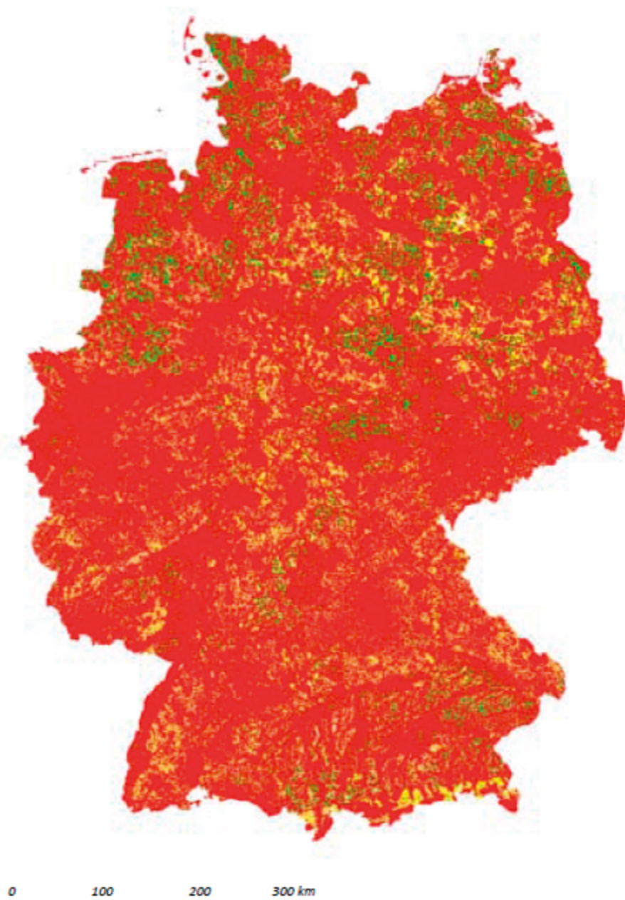
Abbildung C.7: Karten der zur Windenergiegewinnung in Deutschland nutzbaren Flächen. Grün: Flächen ohne Restriktionen (7,9 %); Gelb: Nutzbarer Wald außerhalb von Schutzgebieten (4,4 %); Orange: Nutzbare Flächen innerhalb von Schutzgebieten (10,1 %); Rot: Nicht nutzbare Flächen (77,6 %). (226)
